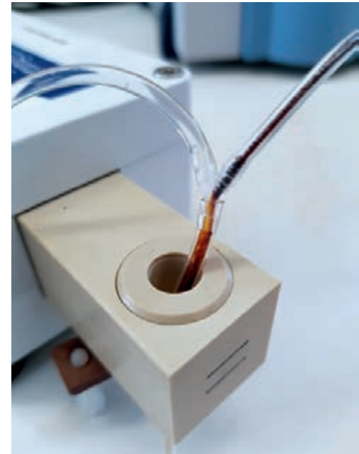
SPIONs werden über ein Y-Stück zum Detektor gepumpt, sodass ein binärer Code entsteht A binary code is produced by pumping SPIONs to the detector channel through a Y-piece
